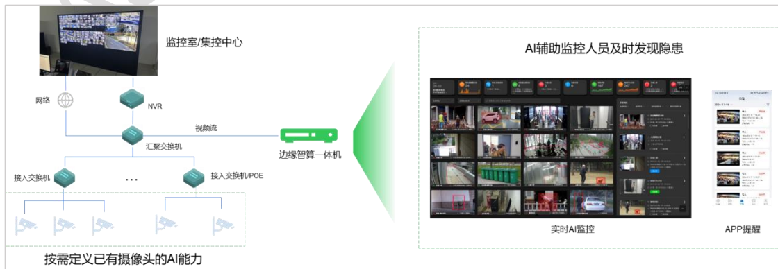
图6-3 无侵入式赋能已有监控网络
